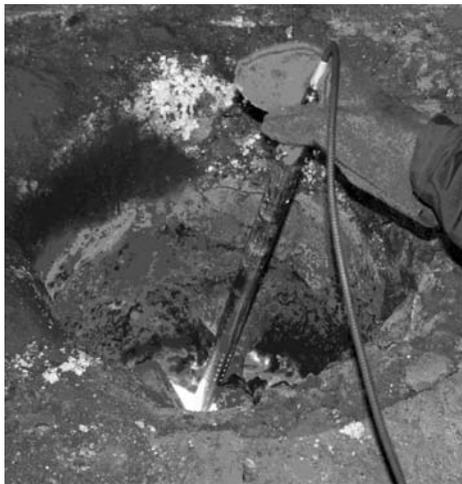
ческих пирометров тем, что приемник ИК-излучения и блок обработки сигнала разнесены с помощью высокотемпературного оптоволоконного кабеля, выдерживающего температуру до 200 °С. Таким образом, приемник ИК-излучения с оптоволоконным кабелем может находиться в зоне измерений с повышенной температурой и электромагнитными помехами — там, где другие электронные приборы выходят из строя.
