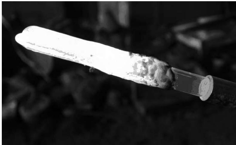
тельность процесса измерений составляет около 30 с, хотя показания установились спустя 4...7 с после ввода чехла в расплав. Скорость ввода чехла в расплав не нормировалась.
